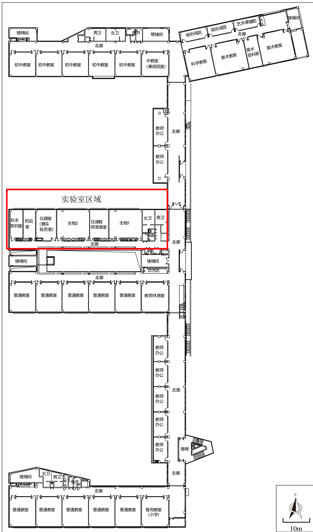
附图 8 九年一贯制学校四层平面布置示意图（带实验室）
